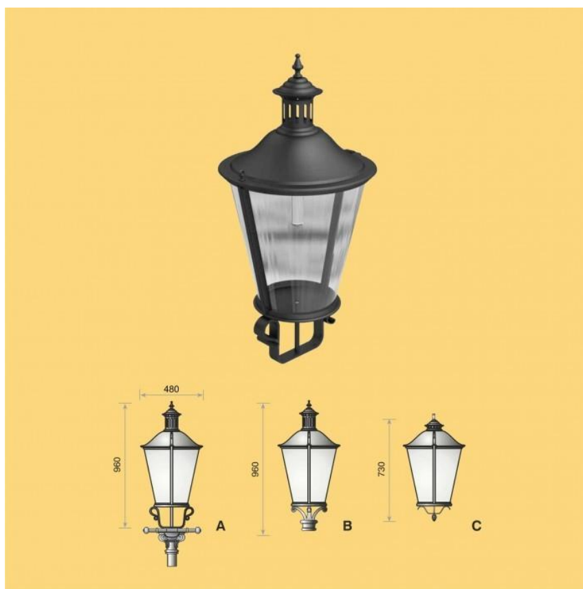
Rysunek 2 - Kształt i wygląd oprawy oświetleniowej parkowej
