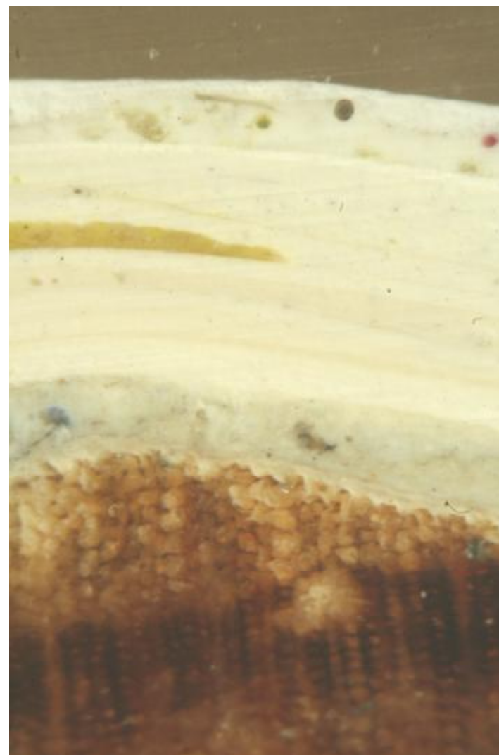
Fot. 108 Przekrój próbki 14. Na drewnie oznaczono 12 warstw farb. Pierwsze dwie warstwy są oryginalne. Drewno malowano najpierw na białą, a potem jasnozielono.
