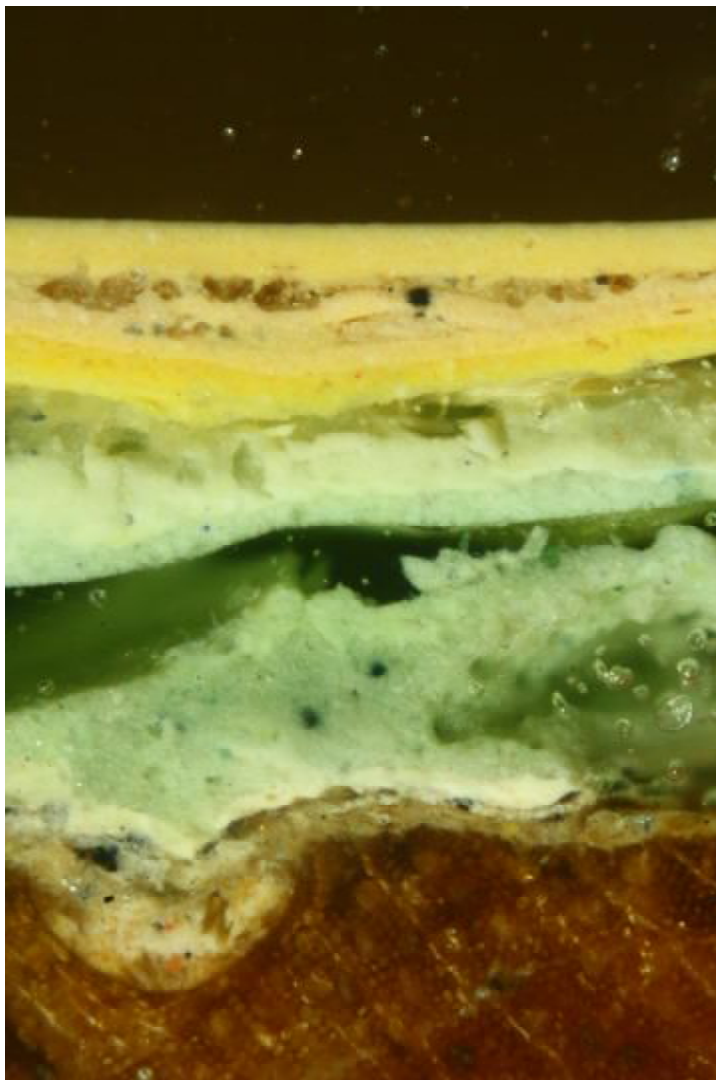
Fot. 145 Oznaczono na drewnie 12 warstw. Pierwsza warstwa to pokost, który przeniknął do warstwy przypowierzchniowej. Druga warstwa, w kolorze jasnobieżowym jest oryginalnym wymalowaniem drewna.
