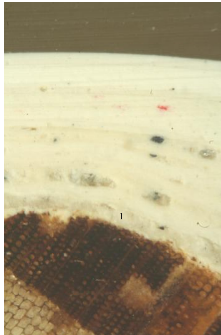
Fot. 93 Przekrój próbki 7. Okno było wielokrotnie przemalowywane. Najwcześniejsza warstwa miała szary odcień, jednak fotografia nie w pełni to oddaje.
