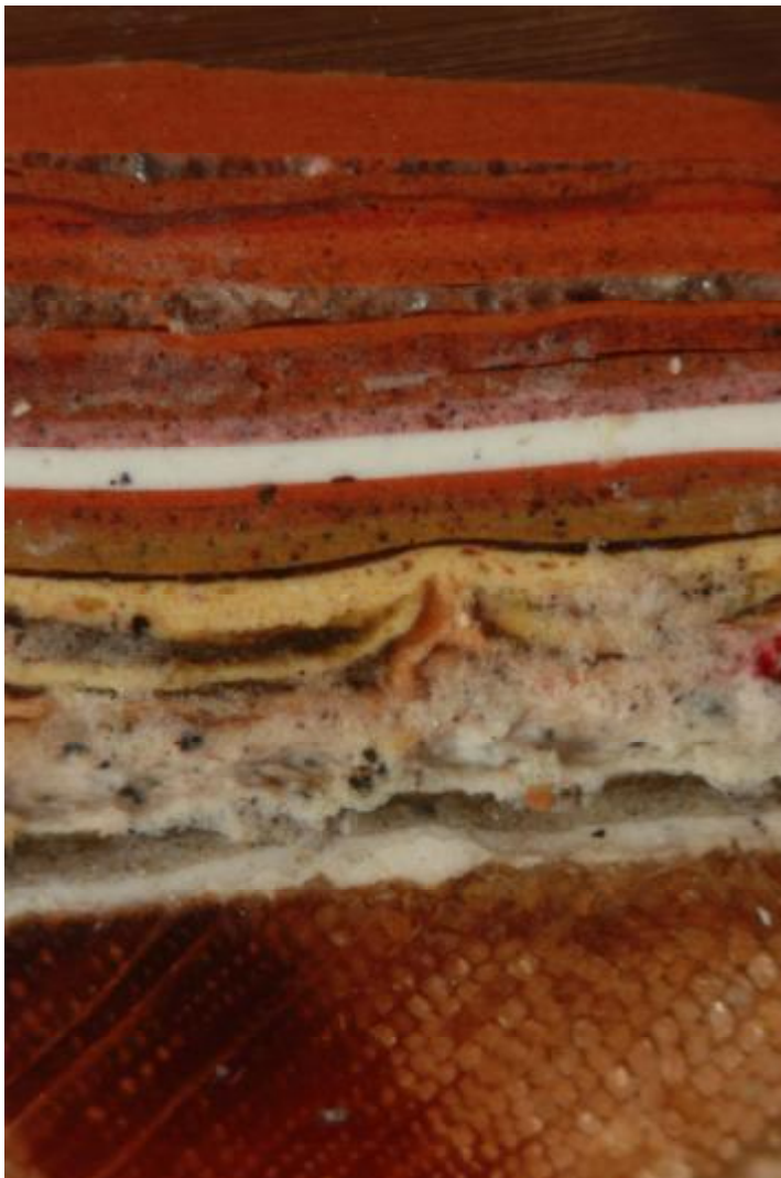
Fot. 130 Przekrój próbki 21. Oznaczono 22 warstwy na drewnie. Oryginalne są wszystkie warstwy do 8 włącznie. Warstwy w kolorze białym i białoszare to warstwy podkładowe, ostatnie z nich stanowią dekoracyjne wymalowanie mazerunkowe.
