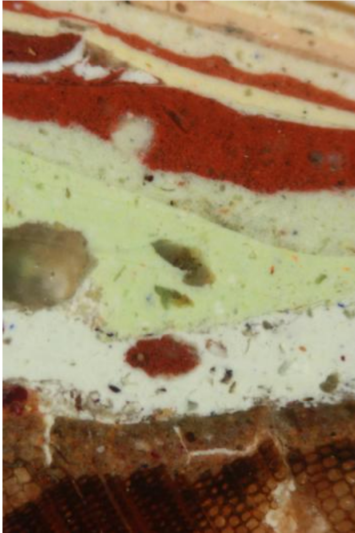
Fot. 121 Przekrój próbki 18. Oznaczono 12 warstw barwnych na drewnie. Warstwy mają bardzo mocno zróżnicowane grubości. Jediną oryginalną farbą może być warstwa 1 w kolorze ciemnougrowym.
