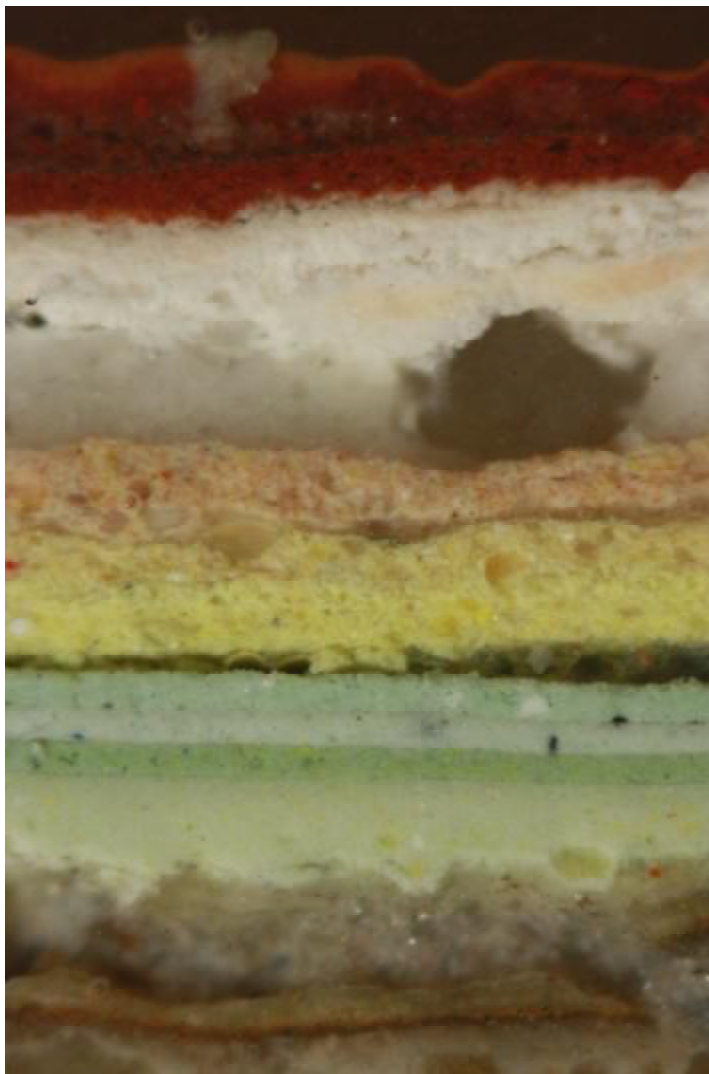
Fot. 140. Przekrój próbki 25. Oznaczono 13 warstw barwnych na tynku. Oryginalny kolor wymalowania profilu był ceglasty.(1)
