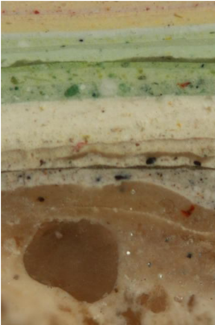
Fot. 142 Przekrój próbki 26. Oznaczono 17 warstw barwnych na tynku. Pierwsze dwie są oryginalne. Na tynk nałożona jest warstwa pobiały, a następnie farba w kolorze biało-beżowym. Pozostałe warstwy są wtórne.
