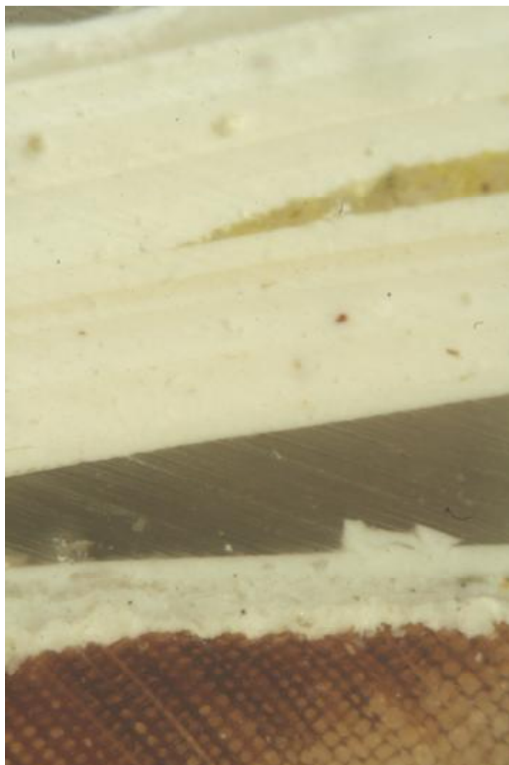
Fot.95, 96 Przekroje próbek 8 i 9 pobranych z drzwi. Jak widać drzwi były wielokrotnie przemalowywane. Druga warstwa była szaro –zielona.
